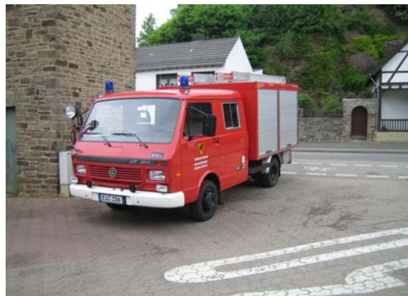
TSF-W (Tragkraftspritzenfahrzeug mit Wasser-tank)
