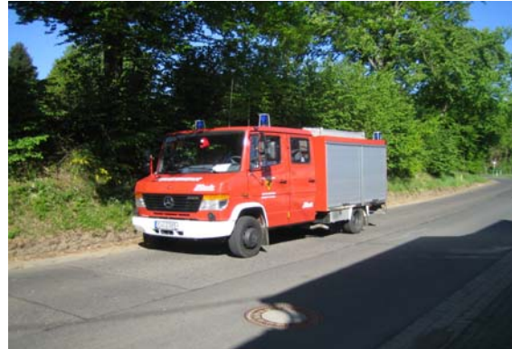
TSF-W (Tragkraftspritzenfahrzeug mit Wassertank)
